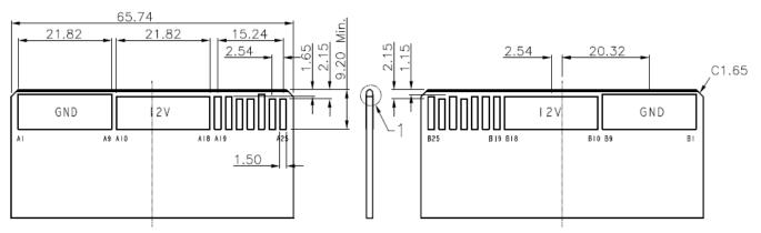
RECOMMEND EDGE CARD LAYOUT (TOP VIEW) THICKNESS IS 1.57±0.13MM; DIMENSION TOLERANCE:±0.05MM
